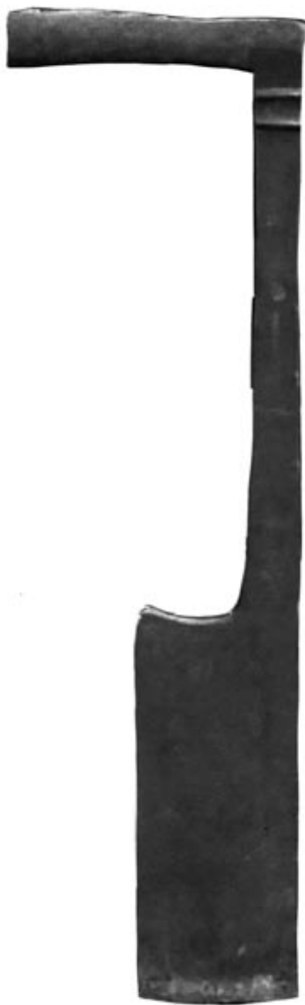
De snik of steekbijl, een oud stuk gereedschap voor het bewerken van hout. Deze is te bezichtigen in het Tabaksmuseum in Amerongen. (Foto uit de collectie van J.Blaas)
