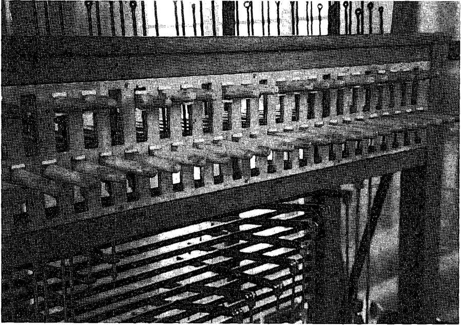
Duidelijk beeld van de toetsen in hun ligplaatsen. Aan de bovenzijde is de verbinding zichtbaar tussen toetsen en klokken (foto H.B. Gieszen)
