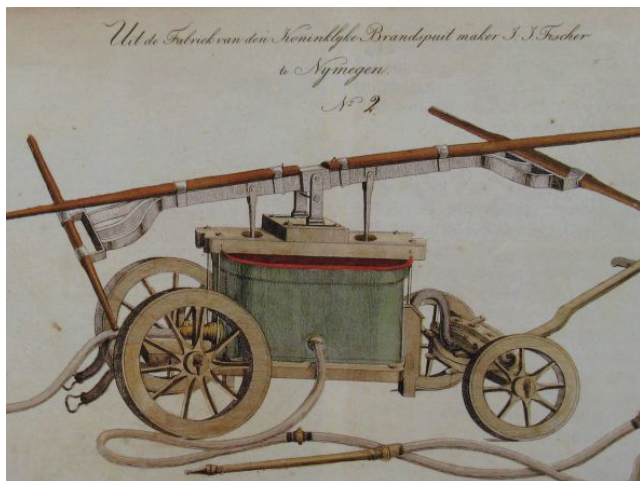
Brandspuit van het type dat in de 18e en begin 19e eeuw nog in gebruik was
